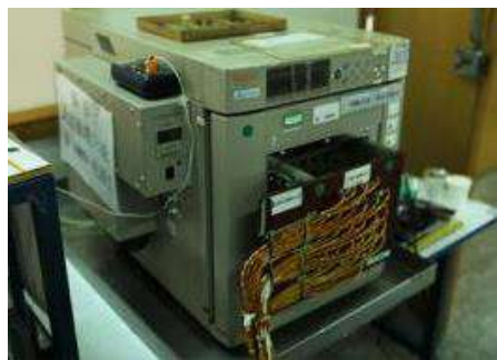
自製整合多台測試設備試驗箱 低溫可達-60 ^{\circ} C，Labview開發控制程式，實現資料自動採集
