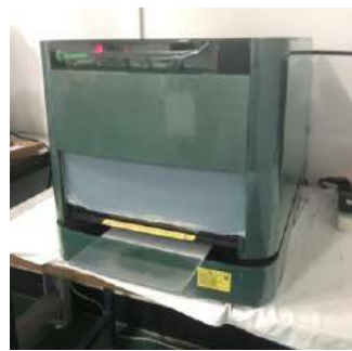
臺式X射線螢光鍍層測厚儀 檢測元素範圍：13號鋁~92號鈾 每層可分析10種元素
