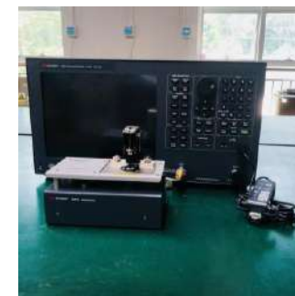
向量網路分析儀 頻率支援5Hz~3 GHz/50或75 \Omega 傳輸/反射或S參數測試
