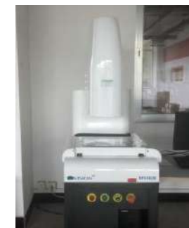
全自動影像測量儀 自動變倍鏡頭0.7~4.5X 90mm工作視距 解析度0.0005mm
